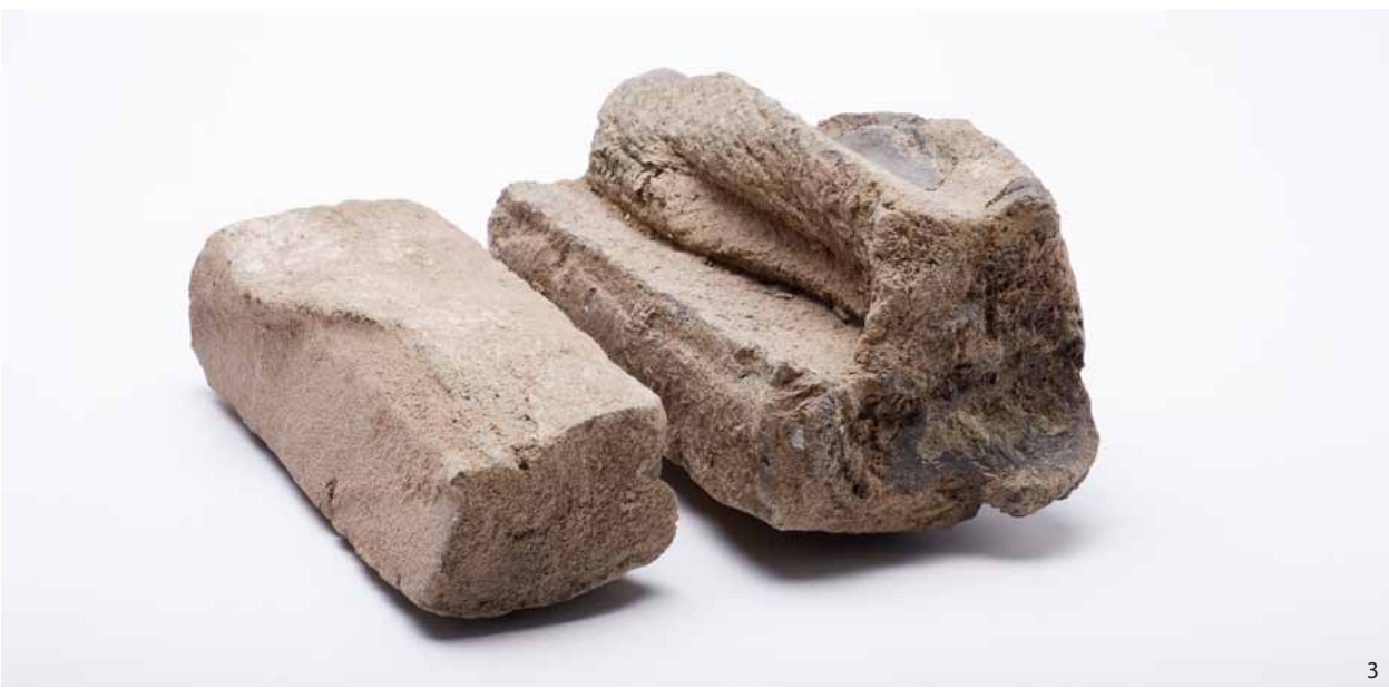
758 Figuur 22.17. Verbrande bakstenen: een blauwgrijze kromgetrokken brok (1), een verbrande baksteen waarvan het breukvlak gelaagd is (2) en enkele complete versmolten bakstenen (3). Schaal 1:2 (1-2), niet op schaal (3). RM
